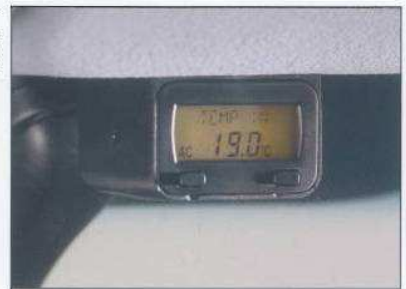
Innen-/Aussentemperaturanzeige mit A/C-Ansteuerung Indicateur température int./ext. avec contrôle A/C Indicatore della temperatura int./est. con impulso A/C
